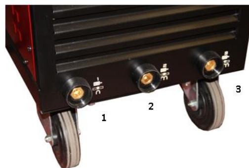
3 posities voor massa-aansluiting (smoorspoelregeling)
